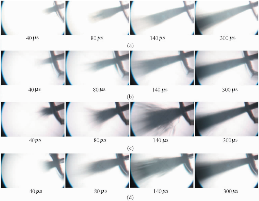
图 8 不同燃料的近场喷雾形态图
