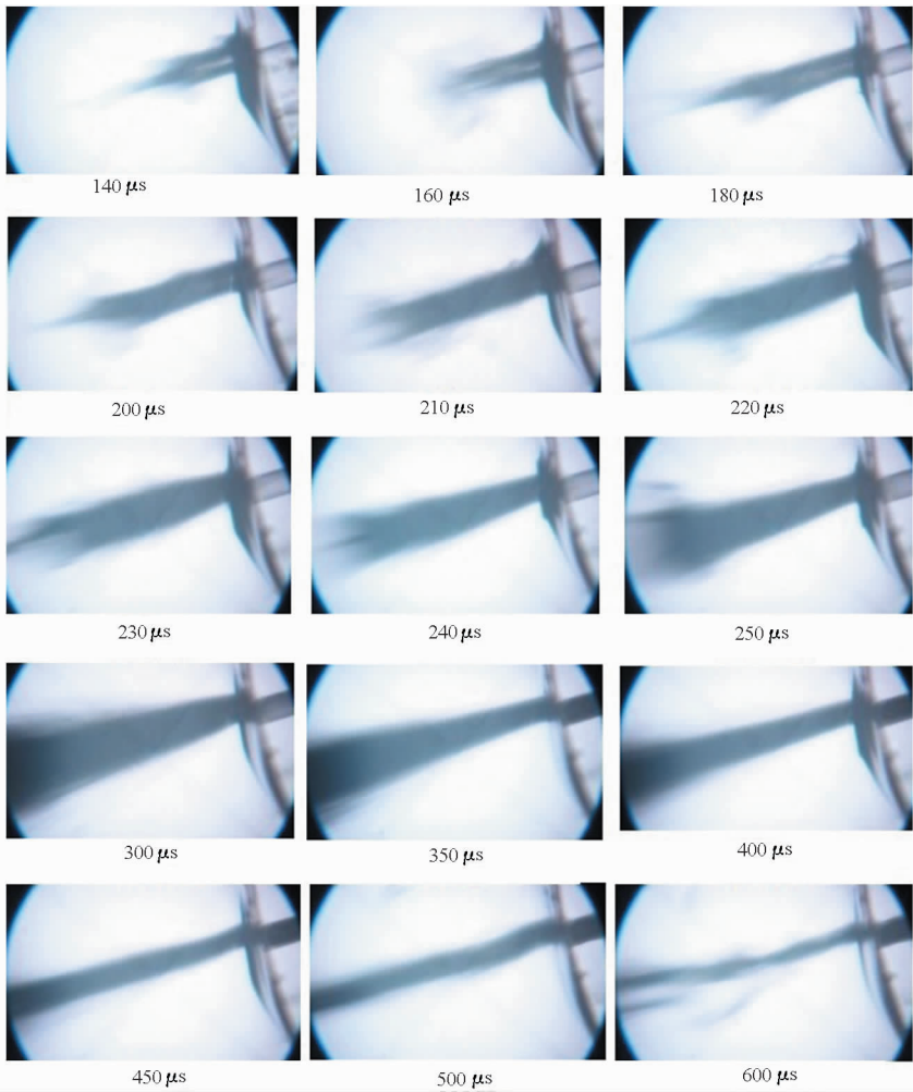
图 6 不同时刻近场喷雾形态图
