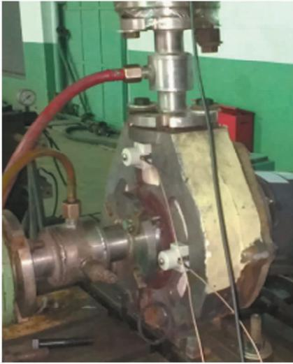
图2 声发射传感器安放位置
