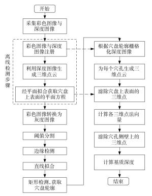
图 2 软件系统流程图
