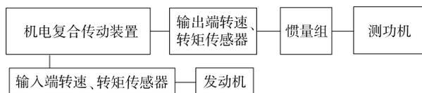
图 6 机电复合传动系统台架试验装置图
