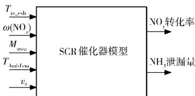
图7 SCR催化剂模型网络结构示意图
