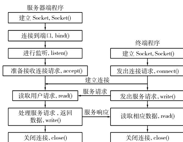
图 4 远程服务器与终端通信程序流程图
